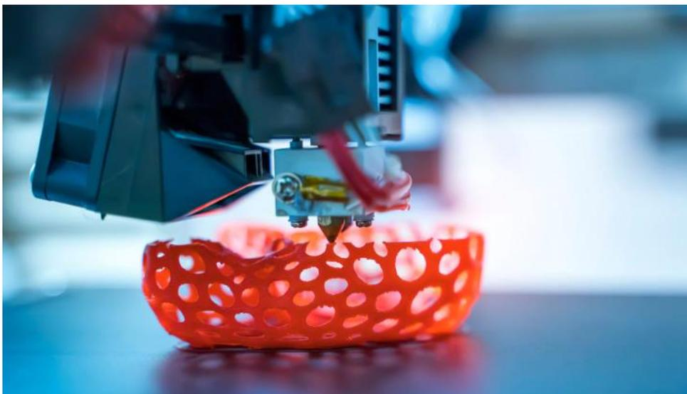
Fig 1- esempio di tecnologia FDM (Fused Deposition Modelling) con materiale polimerico
